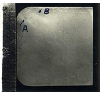
c) 饼坯上的 45° 裂纹 横向低倍 x1/2
