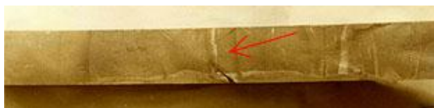
e) 锻制板状件上的十字裂纹 x1/2
