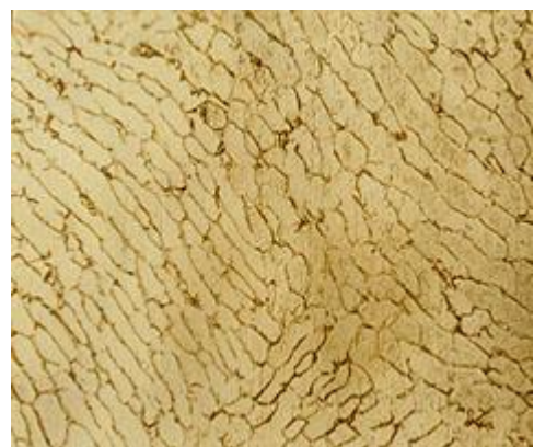
c) 中心粗晶处横向高倍 x500
