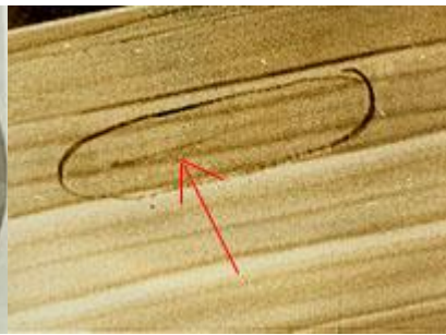
b) 表面裂纹着色渗透显示 x1
