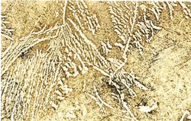
c. 端面表面粗晶的高倍 x100
